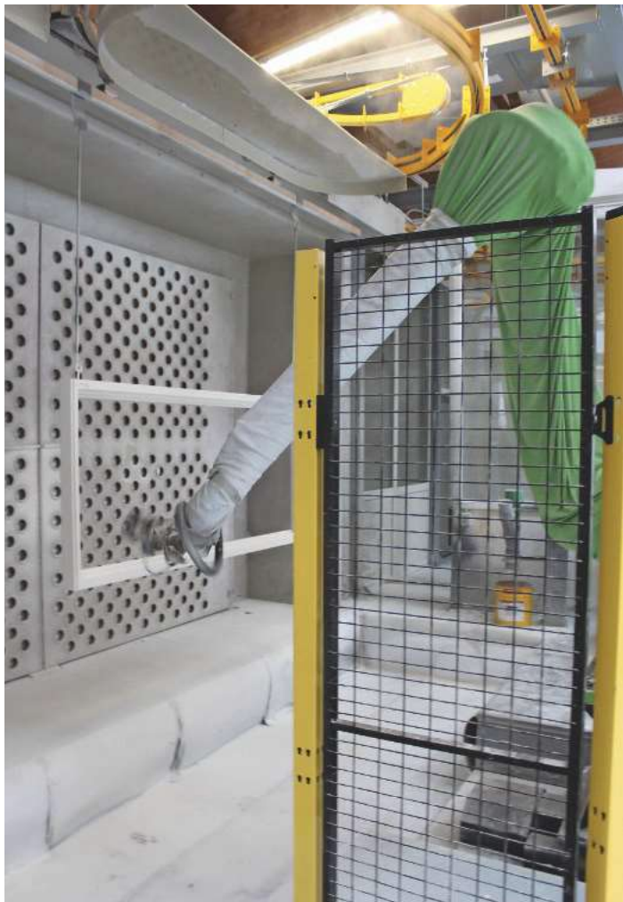
/ Teil des Investitionsprojekts bei Striegel: Range + Heine lieferte die Einzelteil-Imprägnieranlage und den Spritzroboter mit lacksparender Zerstäubungsoptimierung.
