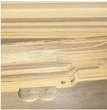
/ Mit CNC-Bearbeitung kein Problem: Wechselfalze und andere individuelle Konstruktionsdetails.
