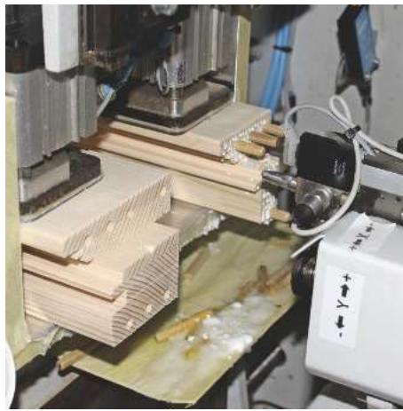
/ Das Dübelcenter Unipin 200 von Weinig automatisiert das Dübeln und sorgt für definierten Leimauftrag.
