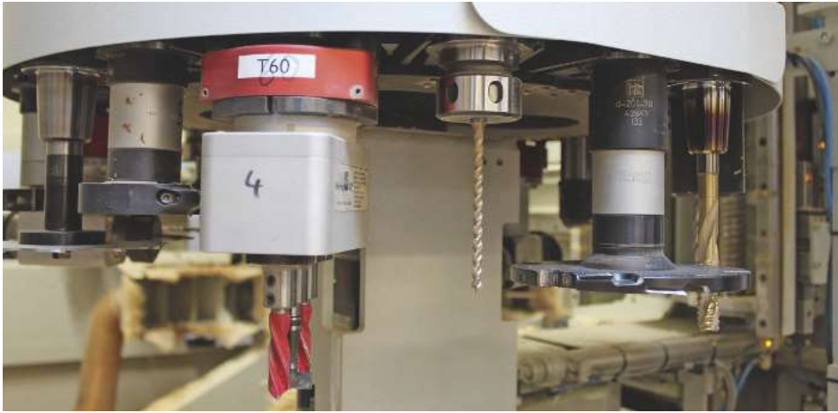
/ Alles an Bord und schnell im Zugriff: Auf dem Teller- und Kettenwechsler sind insgesamt 93 Werkzeugsätze bevorratet. Auch Bohrer und Einzelfräser verfügen über die Leitz-Marathonbeschichtung für längere Standwege.
