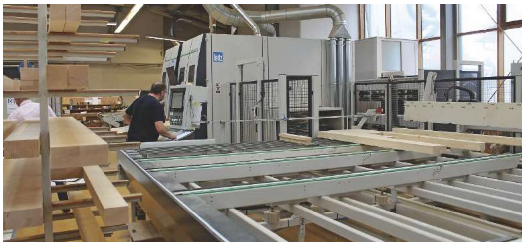
/ Dynamisches Kraftpaket für rund 45 Fenstereinheiten pro Schicht: Das CNC-Profiliercenter Conturex C125 Vario von Weinig mit vier Einzelzangentischen und Parallelbeschickung arbeitet bis zu vier Stunden mannos.
