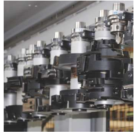
/ Die Wendemesser sind durch die neuartige, präzise Messerspannung im Satz einfach tauschbar.
