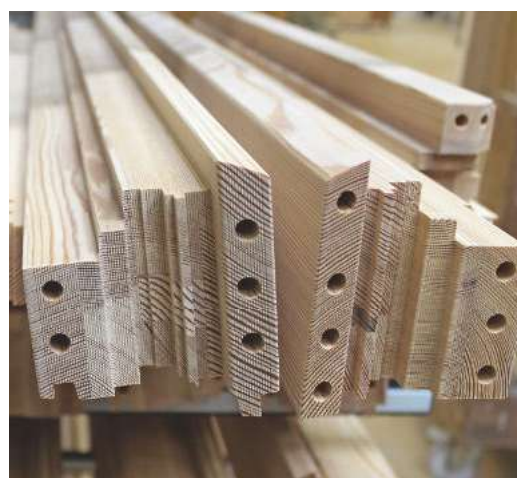
/ Die Dübel-Eckverbindung ermöglicht kurze Bearbeitungs-takte auf der CNC und die Riffeltechnologie von Leitz garantiert dichte Fugen durch eine vergrößerte Leimfläche.
