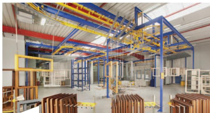
Oberflächenbeschichtung durch das Kältetrocknenverfahren. In die Anlage können auch große Hebe-Schiebe-Türen eingeschleust werden.
