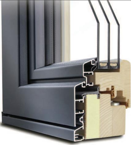
**Eco Idealu: Das Element erreicht einen bei einer Bautiefe von 106 mm einen  $U_w$ -Wert von bis zu  $0,68 \text{ W/m}^2\text{K}$  (mit  $U_g$  von  $0,4$ ).**
