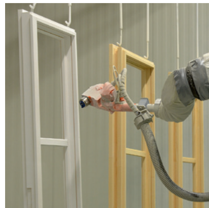
In wenigen Sekunden lackiert der Roboter Fenster für Fenster
