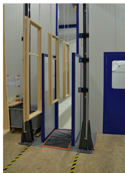
Vor der Roboterlackierung werden die Rahmen vermessen
