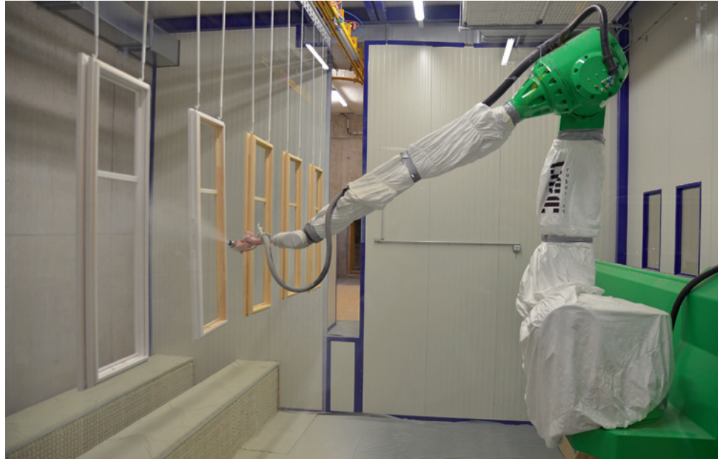
● Mit seinen sechs Achsen lackiert der Roboter von Range und Heine problemlos auch komplizierte Querschnitte
