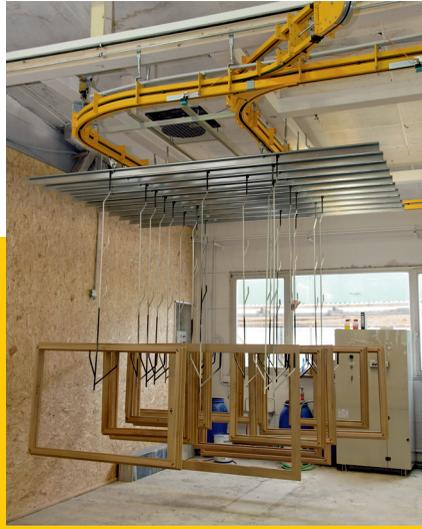
*Im Trockenbereich sorgen Ventilatoren an der Decke für eine erhöhte Luftbewegung und damit eine forcierte Trocknung.*
