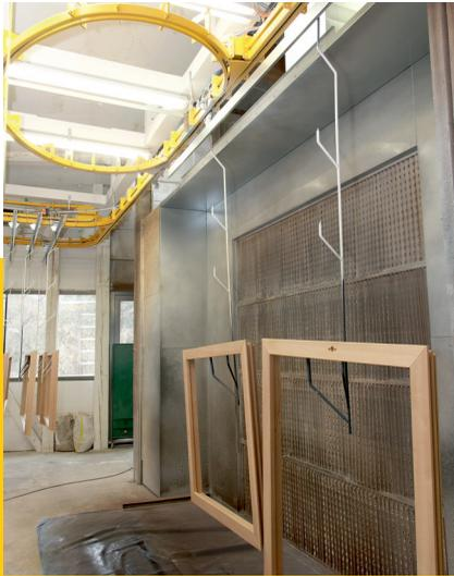
*Im Bereich des Handspritzstandes wurde eine Drehvorrichtung eingebaut, die dafür sorgt, dass das Werkstück sich immer in Idealposition befindet.*
