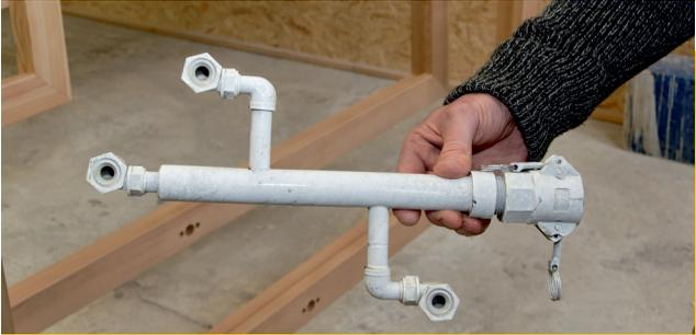
*Die Köpfe der Farblanzen sind mit Düsen in großem Querschnitt ausgestattet. Diese sind dank eines Schnellkuppelsystems schnell austauschbar.*
