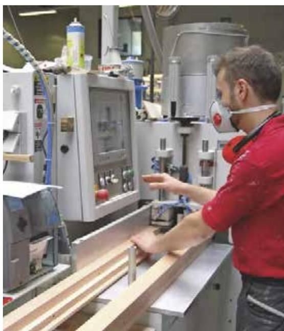
Der Mitarbeiter, der die Conturex beschickt, bedient auch die Dübeleintreibanlage Unipin
