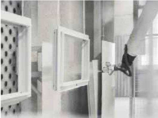
Lackierung mit dem Roboter und Lackrückgewinnung mit dem Robolac-System von Range+Heine
