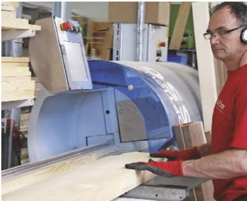
Kantelzuschnitt an der Optimierungskappsäge, mit Maßzugabe 20 mm an jedem Ende
