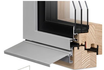
System Contur 3: Alu-Konstruktion mit flacher, kantiger Rahmenschale und schwarz eloxiertem Flügelrahmen. Optional kann ein SFS-Fensterbank-Abdeckprofil für die Altbausanierung (Typ AS) angebracht werden.
