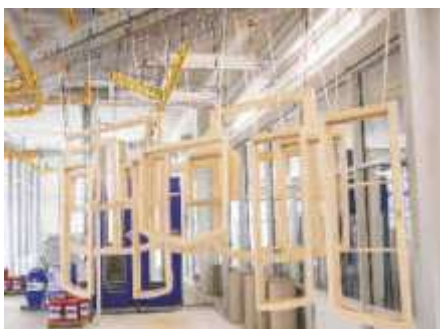
Die Fördertechnik nimmt bis zu 140 Rahmen unterschiedlichster Größe auf
