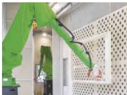
Durch Zerstäubungsoptimierung wird beim Lackieren Druckluft und Lack gespart
