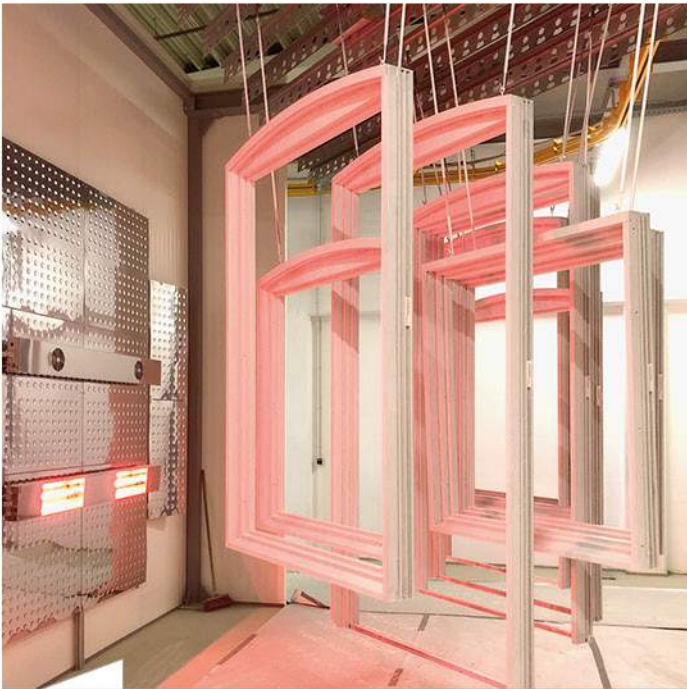
Die Halogentrocknung ermöglicht eine rundherum gleichmäßige Trocknung.
