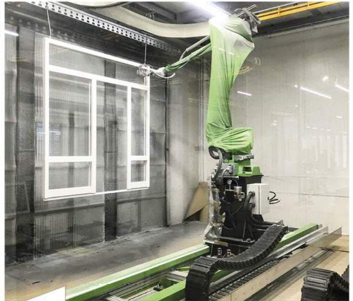
Die Lackierung im Spritzverfahren erfolgt über zwei Roboter, die auf Verfahrwagen montiert sind. Mit einer 3D-Erkennung ausgestattet, ermitteln sie zunächst die Beschaffenheit, wie beispielsweise die Profilstärke der Elemente, um dann die Farbe in einem optimierten Lackierbewegungsablauf gleichmäßig aufzutragen.
