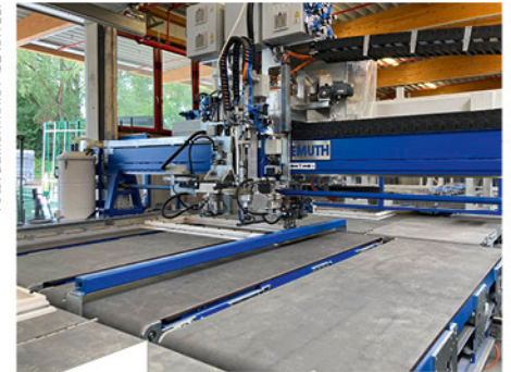
Vollautomatische Montage der doppelseitigen Klebebänder im Überschlag.
