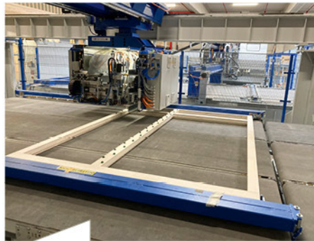
Vollautomatische Klipsmontage von Lemuth für die Aluschalen.
