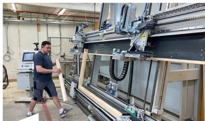
Die Rahmenpresse (S+S) verfährt automatisch. Die Positionierung der Presse erfolgt über Barcode.
