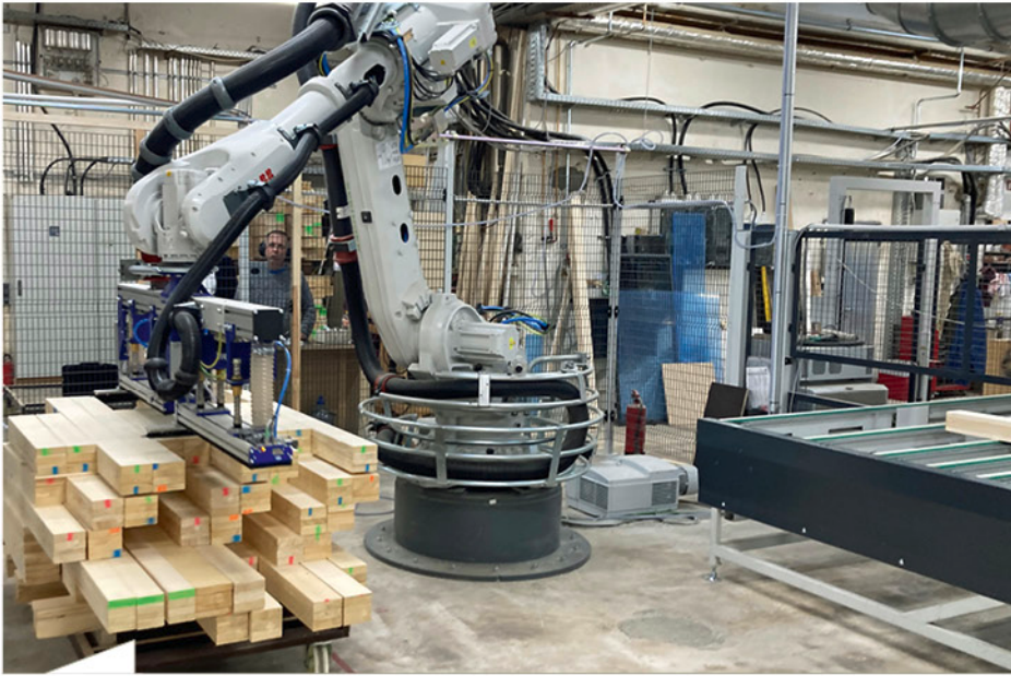
Ein Roboter der Maschinenfabrik Springer erledigt den Abstapelvorgang und die Zuführung auf die Kapphobelinie vor der Conturex-Systemanlage.
