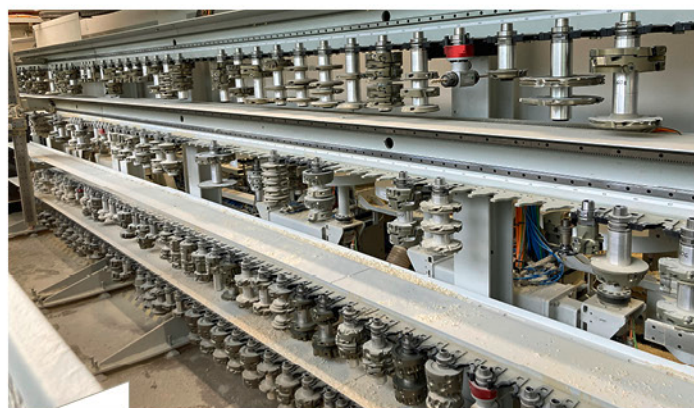
Blick auf einen Teil des Werkzeugwechslers mit 660 Werkzeugplätzen und automatischer Waschmaschine (zwischen beiden Magazinen) zur Reinigung der Werkzeuge.
