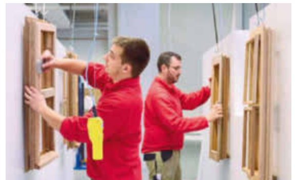
Der Zwischenschliff erfolgt ergonomisch und effizient am hängenden Rahmen
