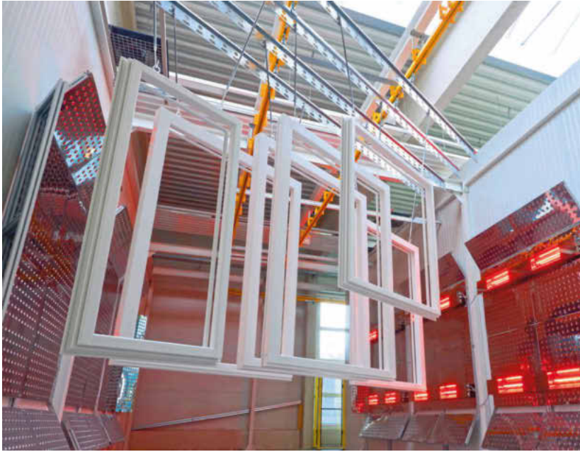
Halogentrocknung: Blockfestigkeit nach 90 Minuten. Und das bei einem geringeren Energieeinsatz als mit konventioneller Entfeuchtungstrocknung
