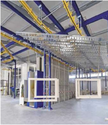
/ Auch wenn die Traverse schon auf dem Weg ist, kann ihr Ablauf noch umprogrammiert werden.
