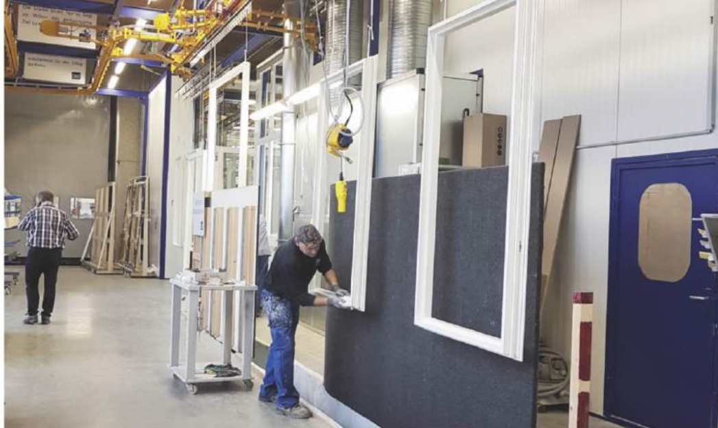
! Mit der Hubabsenkung ist es möglich, den Zwischenschliff durchzuführen, ohne das Fenster abhängen zu müssen.
