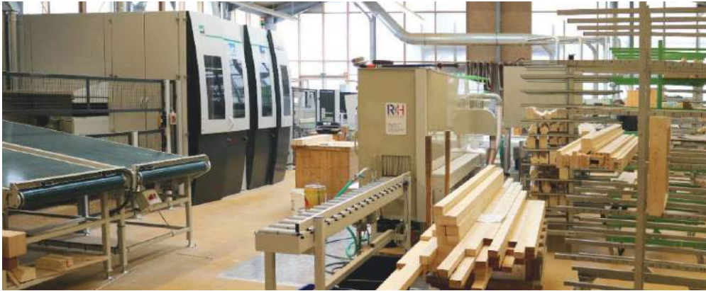
Grundierung am Einzelteil im Fluttunnel Flowcoroll G/P+ von Range + Heine
