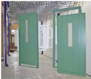
Trockenstrecke: Raumtemperatur mit Luftzirkulation und kontrollierter Luftfeuchte
