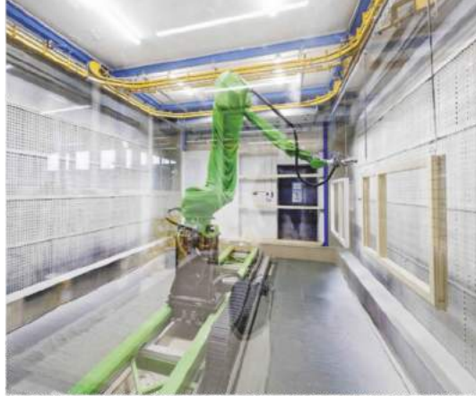
Über mehrere Verschiebeachsen kann der Lackierroboter auch großen Werkstücken gerecht werden.
