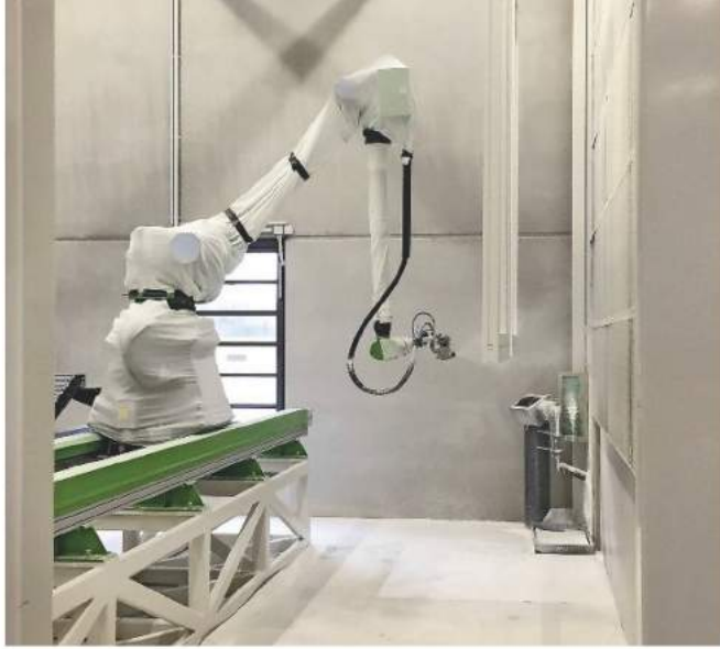
/ Mannloser Oberflächenauftrag mit automatischem Farbwechsel: Lackiert wird mit einem CMA-Sechssachs-Spritzroboter samt 2D sowie Tiefen- und Schräglagen-Erkennung.
