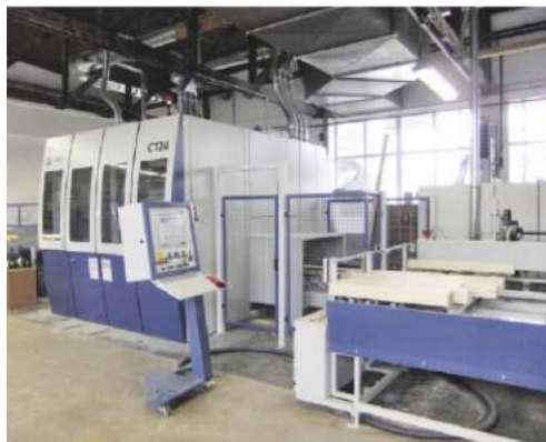
! ... hat das Unternehmen seit dem Jahr 2010 auch ein flexibles CNC-Bearbeitungszentrum vom Typ Conturex 124 im Einsatz.
