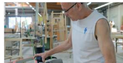
Handschleifen ist bei Qualitätsprodukten nach wie vor notwendig, um Falze zu schleifen und Kanten zu brechen
