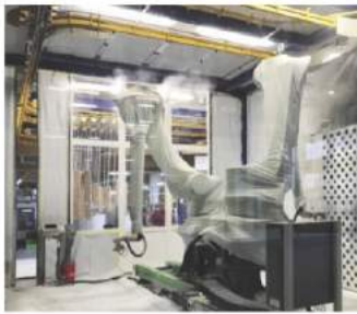
Die CMA-Spritzroboter mit 2D-, Tiefen- und Schräglagenerkennung lackieren im produktiven Duett.
