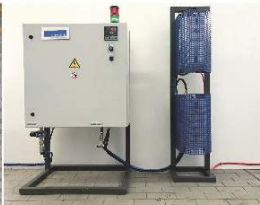
«G eheimwaffe» zur Lackeinsparung bei Striegel: die Airmatic-Zerstäubungsoptimierung
