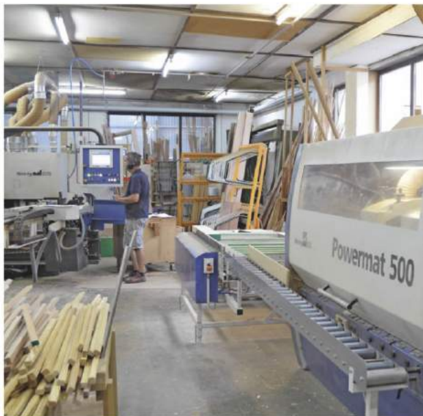
Friedrich fertigt seine Schlitz- und Zapfenverbindungen mit einer UC 6 von Weing, gehobelt und profiliert wird mit einem Powermat 500
