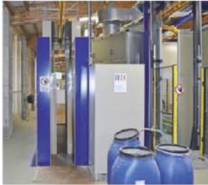
Für Grundierung/Imprägnierung: Flutanlage Flowcomat P+ von Range + Heine
