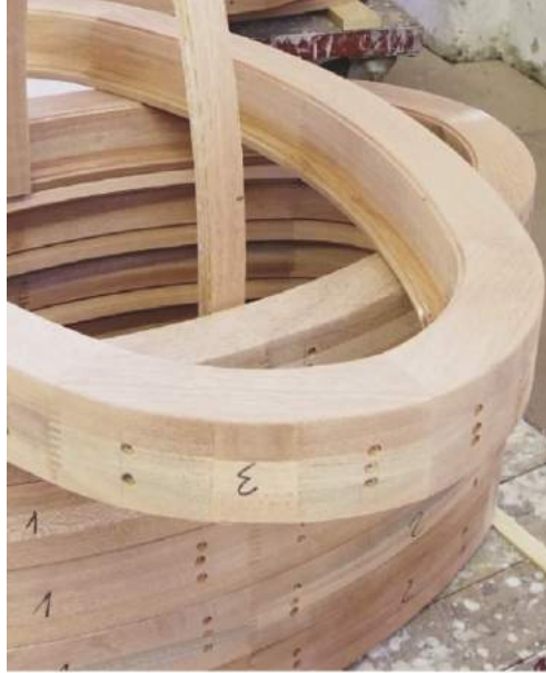
! Rund – na und? Dank flexibler CNC-Maschinentechologie kann das Unternehmen nahezu jede Fensterform realisieren.
