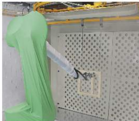
Der Spritzroboter GR 6100 von CMA ist mit Pistolenreinigungsstation und zwei Pistolen auch für kleine Lössgrößen ausgestattet
