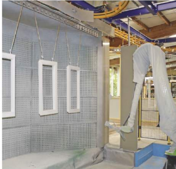
Der Roboter lackiert die Flügel zunächst von vorn, dann wird gedreht und rückseitig lackiert. Er arbeitet ca. 50 Traversen am Tag ab
