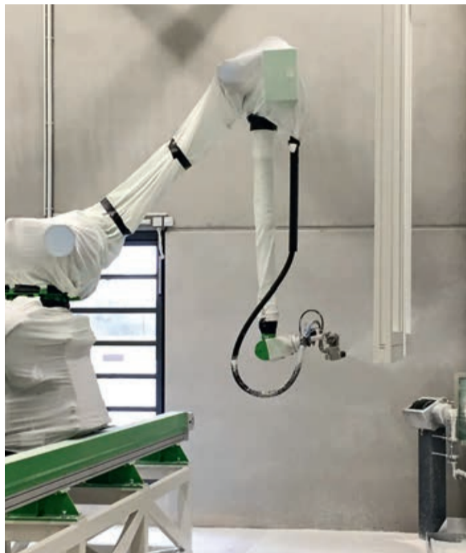
Lackiert wird mit einem 6-Achs-Spritzroboter, der mit vier Farbumpen, einer Spülpumpe und einem automatischen Farbwechsel ausgestattet ist.
