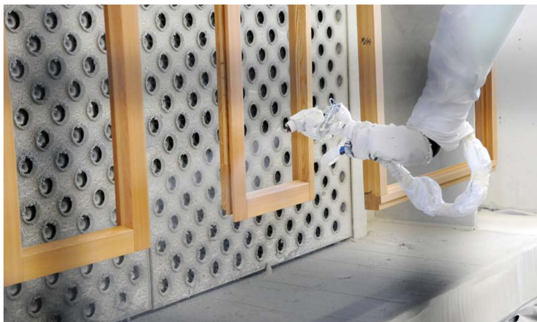
Bei reinen Holzfenstern werden 60 bis 70% deckend lackiert. Ein Farbwechsel dauert ca. 20 min.
