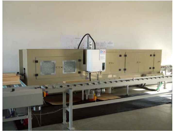
Zur Imprägnierung /Grundierung durchlaufen die Einzelteile für Fensterflügel und -rahmen den 1 m breiten und 5 m langen Flutunnel.
