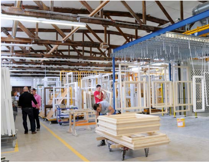
Nach der Grundierung werden die Einzelteile zu Flügeln und Rahmen verleimt, mit Eindrehankeuren ausgestattet und für die Decklackierung aufgehängt.
