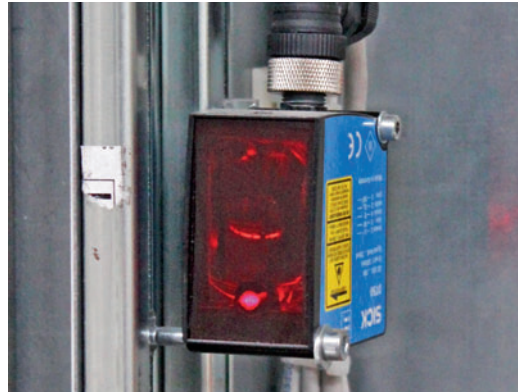
/ Mittels Lasermessung werden die Werkstückdicke und -neigung im hängenden Zustand sehr genau ermittelt.
