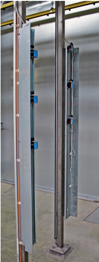
/ Hier werden die Teile exakt erfasst: Scanstation mit Lichtleiste und Laser.
