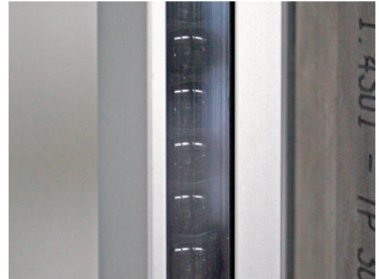
/ Genaue Objekterkennung: Die Lichtleiste erzeugt einen Lichtvorhang im 10-mm-Raster.
