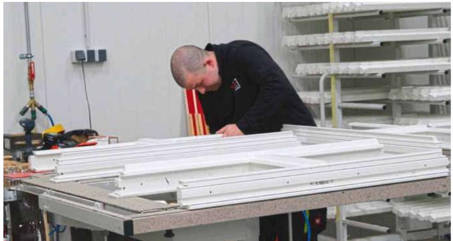
Zusammenbau der fertig lackierten Einzelteile: die Schraub-/Dübelverbindung »hält Bombe« so Christian Michels, sie ist geprüft bis RC3
