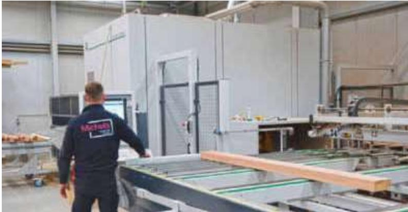
Produziert wird bei Michels auf dem Bearbeitungszentrum Conturex Compact von Weinig. Verarbeitet wird überwiegend Meranti
