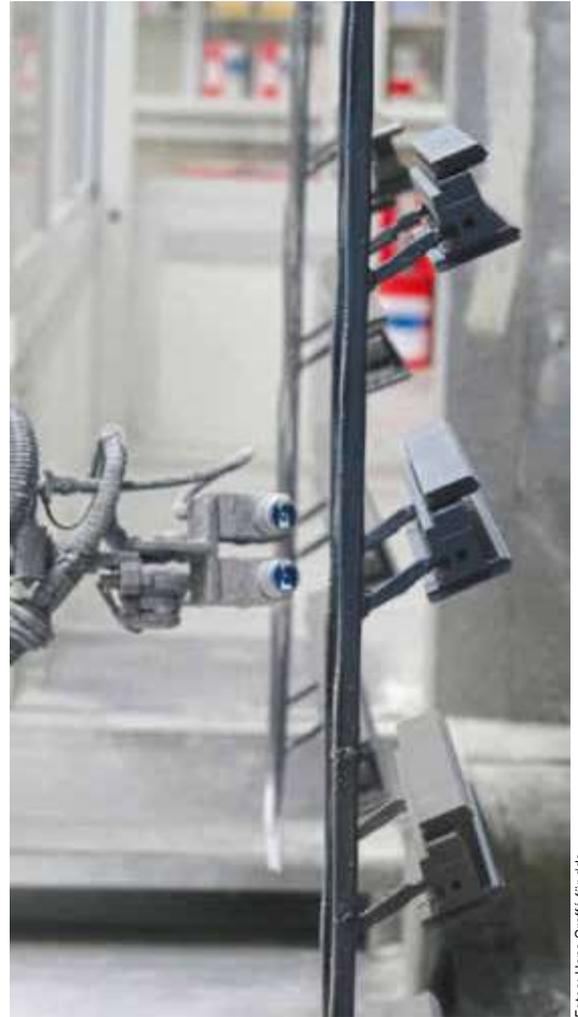
Er ist mit zwei Pistolen bestückt: eine für Einzelteile, eine für Rahmen
