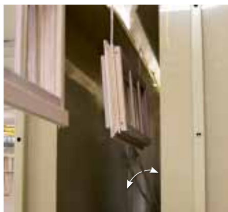
Die Grundierung wird von zwei Düsen aufgebracht, die sich auf und ab bewegen (eine im Bild)
