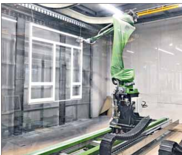
Die Endbeschichtung erfolgt mit zwei Robotern, die auf Verfahrwagen montiert sind.
