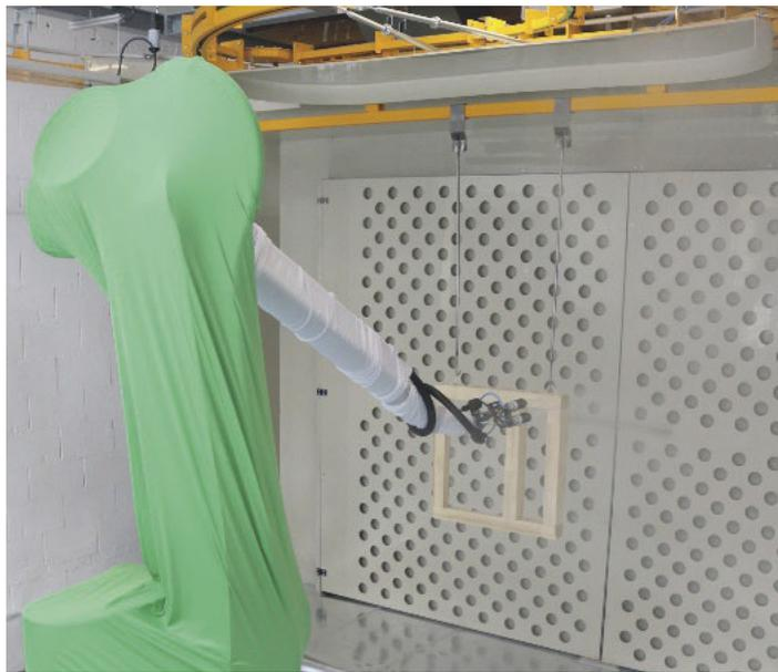
Der Spritzroboter GR 6100 von CMA ist mit Pistolenreinigungsstation und zwei Pistolen auch für kleine Losgrößen ausgestattet
